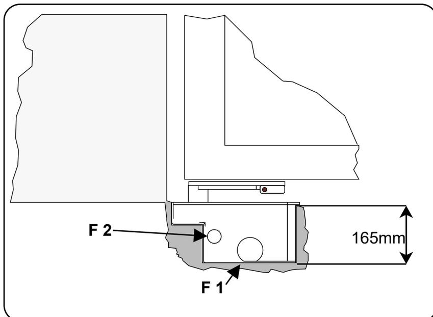
**Nota:** nel posizionare la cassetta, tenere conto della distanza minima che deve esserci tra il pilastro e il centro di rotazione della cerniera del cancello.
