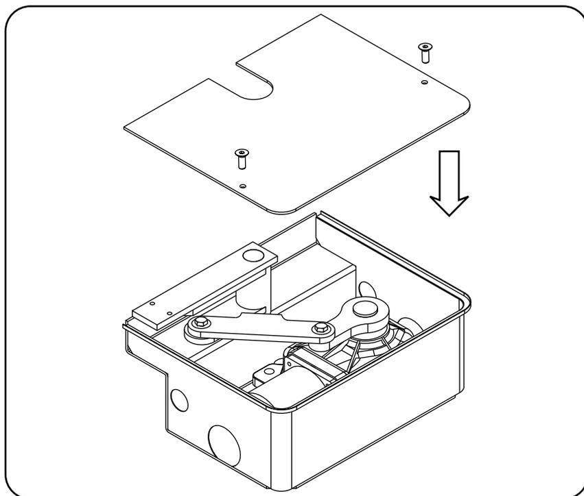
Posizionare l'anta del cancello e la leva (L1) in modo che siano perfettamente allineate e fissarle mediante saldatura o altro.
