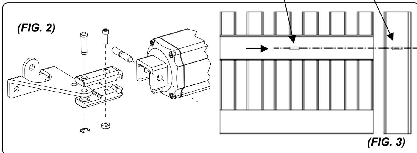
**Attenzione!** Nel determinare l'altezza da terra a cui fissare la piastra sul pilastro(FIG.1), tenere conto che la piastra per l'ancoraggio del pistone sul cancello deve essere fissata allo stesso livello. (FIG.3)
